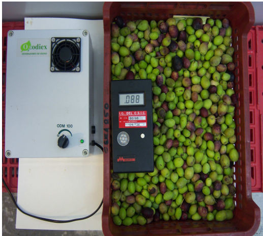
Fig. 10.- Aceitunas en atmósfera ozonizada y 4 °C. Ozonizador y medidor de ozono.
